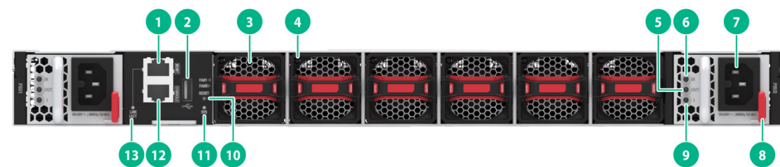
图2-5 S9800-32D 后面板示意图
